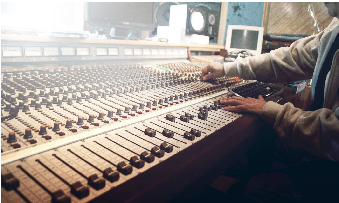
3. Operador trabajando sobre una gran consola analógica durante una sesión de producción. La fotografía refleja la etapa de mezcla de una producción musical y el ajuste manual de niveles, panoramas y parámetros de cada canal.
