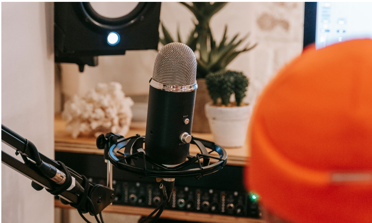
9. Micrófono de condensador, monitor de estudio y consola en un espacio de grabación. La fotografía ilustra una cadena básica de producción: captación con micrófono, control de niveles, monitoreo y posterior procesamiento del audio.
