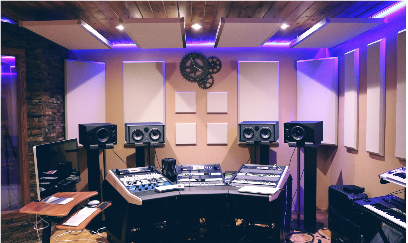
1. Estudio de producción sonora con monitores de campo cercano y tratamiento acústico. La escena representa el posicionamiento de monitores, el punto de escucha o "sweet spot" y el entorno técnico necesario para trabajar con audio con mayor precisión.
