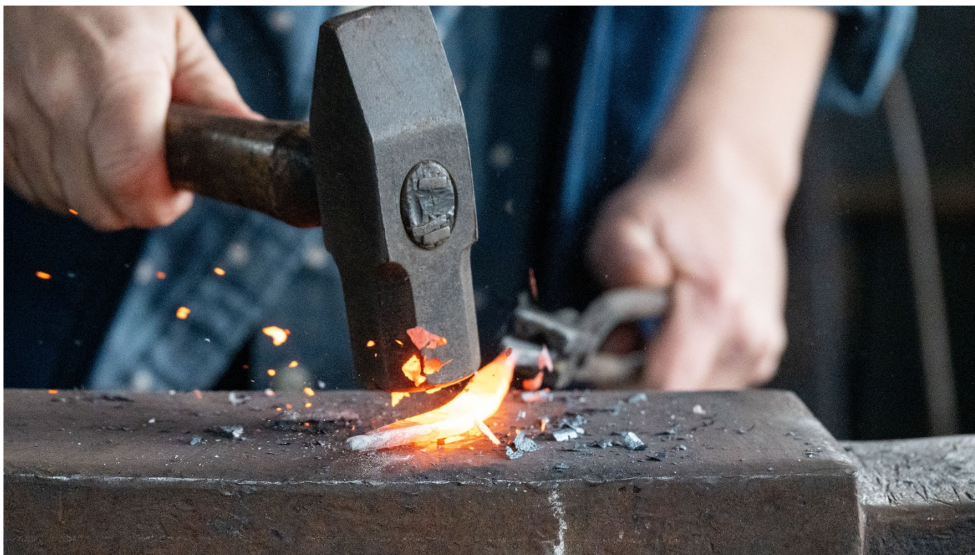
Foto 9. Golpeado y conformado del acero al rojo vivo: etapa central del forjado para definir progresivamente la geometría de la hoja.
