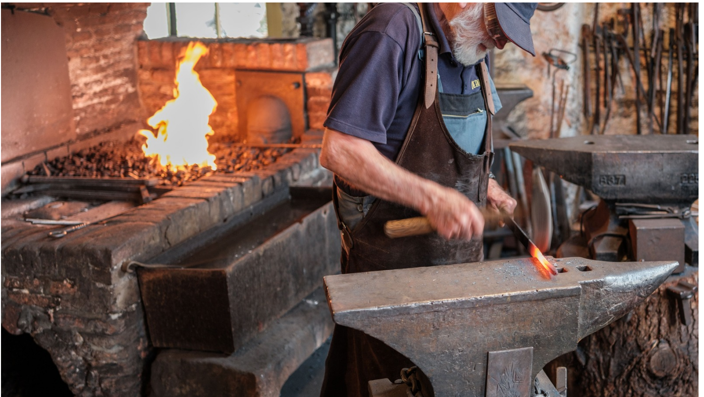
Foto 8. Forjado en caliente sobre yunque: uso de martillo, calor y control de la forma para transformar el acero durante la fabricación.
