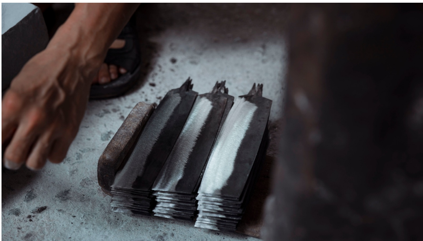
Foto 10. Piezas de acero en proceso de desbaste: preparación de hojas antes del lijado, amolado, tratamiento térmico y pulido.
