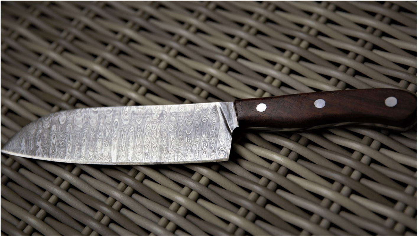
Foto 3. Cuchillo artesanal de acero damasco con mango de madera: integración de hoja, remaches, empuñadura y terminación final.
