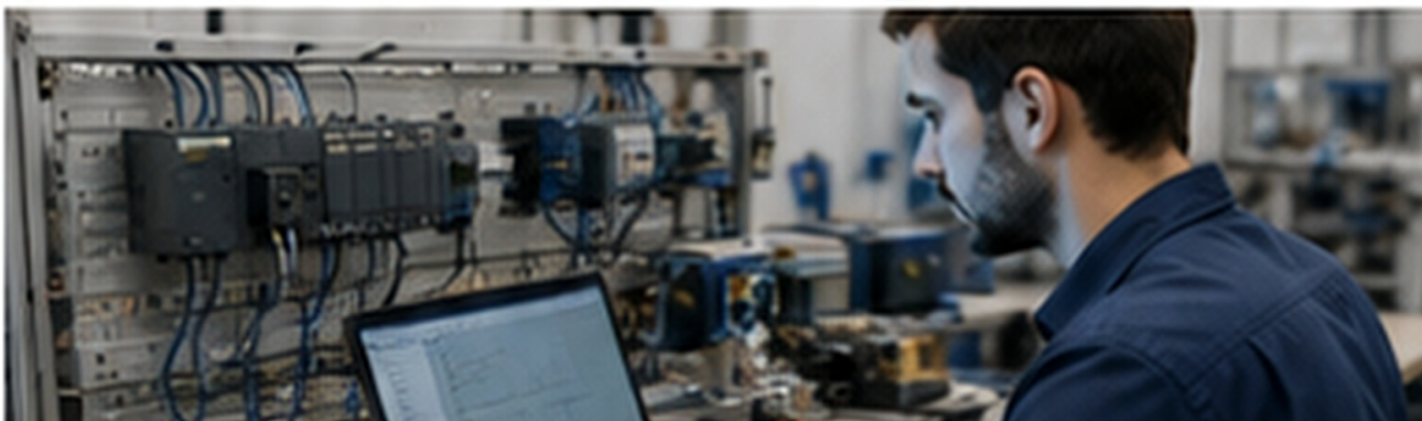
FOTO 10 Práctica de configuración y diagnóstico de un sistema PLC, combinando programación, cableado y comprobación del funcionamiento.
