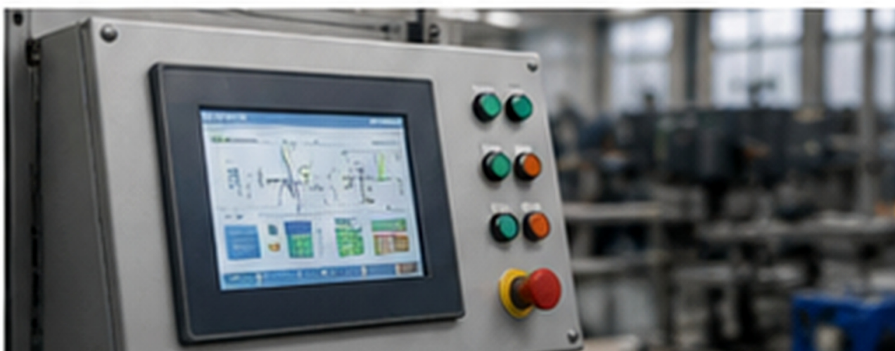
FOTO 8 Panel de operación y control utilizado para visualizar estados y accionar funciones de una instalación automatizada.
